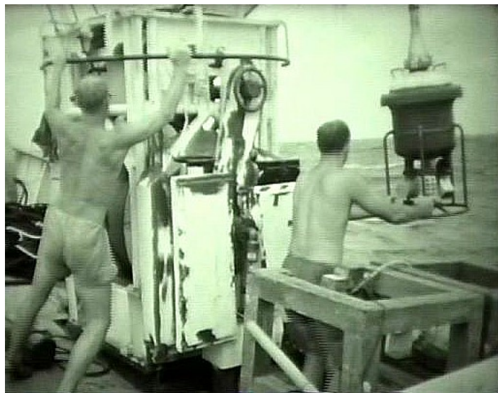
FRIEDRICH MÖCKEL und EDGAR BENGELSDORFF beim Aussetzen des TS-Fühlers mit der ersten Version der „Penck“-Winde im tropischen Atlantik im Jahre 1964 (IOW 1964,2).
