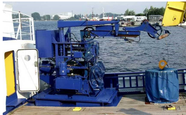
Die legendäre CTD-Winde auf FS „Professor Albrecht Penck“. Die Winde geht auf die TS-Fühlerwinde zurück, die 1960 montiert und später mehrfach umgebaut und 1979 mit der hydraulischen Auslegetechnik versehen wurde (s. auch Anhang A VII).
