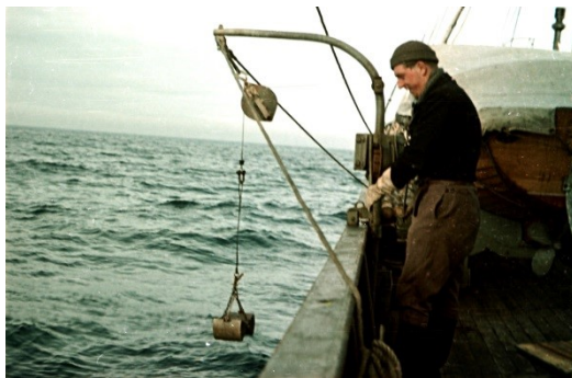
Entnahme von Bodenproben mit einem PETERSEN-Bodengreifer und Begutachtung der Probe.
