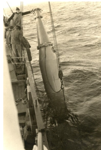
Gesamtansicht und Überwasserteil der Messboje bei der Erprobung von Bord des VS „Joh. L. Krüger“ im Juli 1957.
