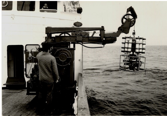
Ozeanologische Messkette OM 75 an der legendären Winde mit spezieller Vorrichtung für das Hieven der Sonde über das Schanzkleid im Jahre 1979 (Foto: IOW).
