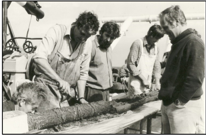
Untersuchung eines Stechrohrkerns auf dem Hauptdeck des FS „A. v. Humboldt“ (links stehend GERD BENING; ganz rechts WOLFGANG MATTHÄUS (Foto: IOW-Bildarchiv).
