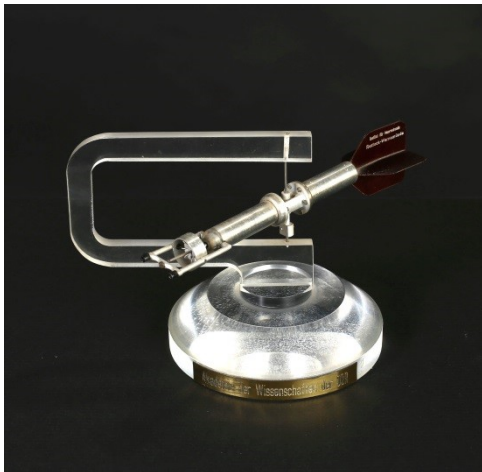
Modelle der im IfM entwickelten ozeanographischen Standard-Messsysteme, des Serienströmungsmessers LSK 801 (links, ca. 15 cm) und der Ozeanologischen Messkette OM 75 (Ø ca. 10 cm), angefertigt von Feinmechanikermeister EWALD GEYER in den 1970er Jahren (Fotos: J. BÖHNKE).
