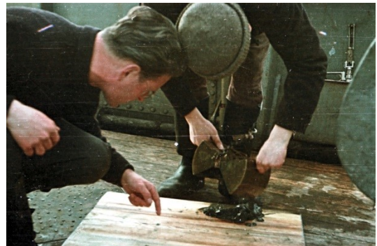
Entnahme von Bodenproben mit einem PETERSEN-Bodengreifer und Begutachtung der Probe.
