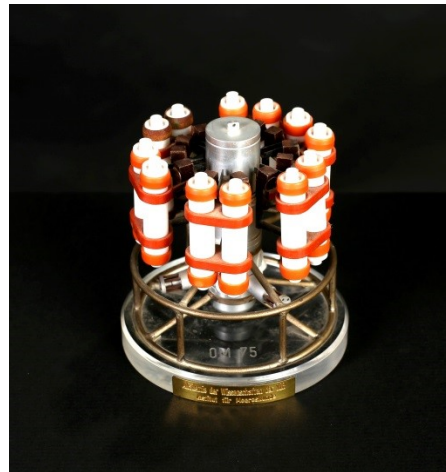
Modelle der im IfM entwickelten ozeanographischen Standard-Messsysteme, des Serienströmungsmessers LSK 801 (links, ca. 15 cm) und der Ozeanologischen Messkette OM 75 (Ø ca. 10 cm), angefertigt von Feinmechanikermeister EWALD GEYER in den 1970er Jahren (Fotos: J. BÖHNKE).
