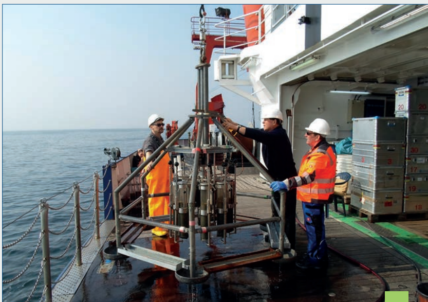
Multicorer im Einsatz auf dem FS ALKOR während der ersten gemeinsamen SECOS-Ausfahrt. / Multicorer in operation during the first joint SECOS cruise with the RV ALKOR. (Foto / Source: IOW)
