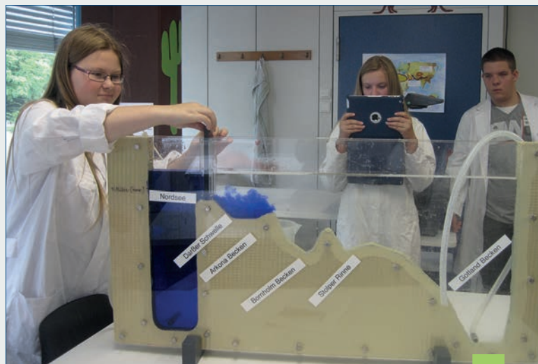
Abb. 1: Schüler simulieren den Einstrom von Salzwasser in die Ostsee in einem vom IOW entwickelten Modell. / Fig. 1: Pupils simulate the inflow of salt water into the Baltic Sea with a model developed at IOW. (Foto / Source: IOW)
