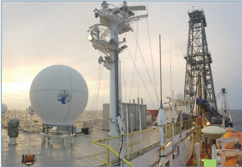
Mit dem 62 m hohen Bohrturm kann der Spezialbohrer der JOIDES RESOLUTION bei einer Wassertiefe von 6000 Metern Bohrkerne aus dem Meeresboden entnehmen. / With the 62 m high derrick, the special drill of the JOIDES RESOLUTION can obtain cores from the seabed at a water depth of 6000 meters. (Foto / Source: H. Arz/IOW/IODP)
