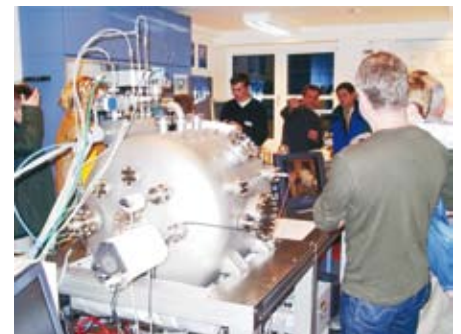
Angeregte Gespräche von IAP Mitarbeitern mit den zahlreich erschienenen Besuchern beim Tag der offenen Tür am 29. November 2003. Hier wird die Funktion eines Vakuumpumpstands für Test und Kalibrierung von Instrumenten auf Höhenforschungsraketen erläutert.
