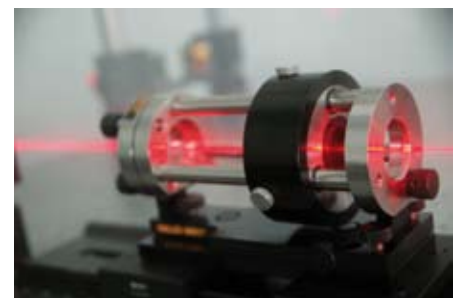
Apparatur für die Cavity Ring-Down Spektroskopie und Laserstrahl (mittels Flüssigstickstoff für das menschliche Auge sichtbar gemacht)
