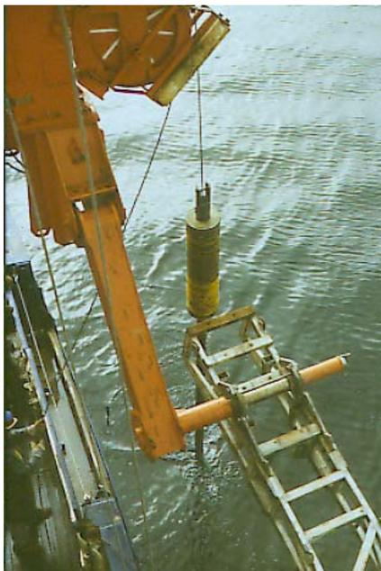
Bei Kernlängen von mehr als 6 m wird generell mit einem Kernabsatzgestell gearbeitet, welches an der Bordwand des Schiffes befestigt ist und einen gefahrlosen Einsatz des Gerätes ermöglicht.
