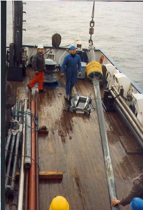
**Abb. 5.5.:Schwerelot beim Einsatz ohne Kernabsatzgestell an Bord von FS „A.v. Humboldt“**
