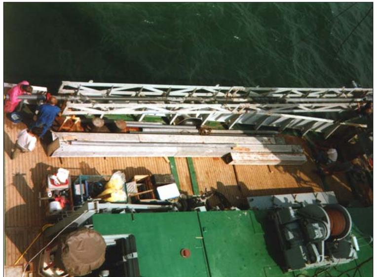
**Abb. 5.6. Schwerelot im Kernabsatzgestell an Bord von FS „Petr Kotsov“**
