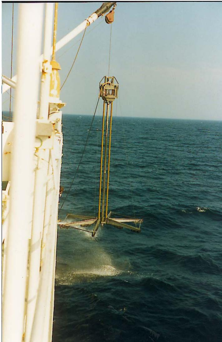
**Abb. 5.10.: Bergung des 6 m langen IOW-Vibrationskerngerätes an Bord von FS „A.v. Humboldt**
