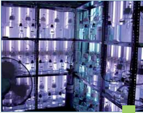
ABB. 2: GROSSVERSUCH ZUM EINFLUSS DER OZEAN-VERSÄUERUNG AUF CYANOBAKTERIEN UND DEN ABBAU GELÖSTEN ORGANISCHEN MATERIALS AM IOW 2010. DER ANSATZ UMFASSTE 40 ZEHN-LITER-FLASCHEN. / EXPERIMENT ON THE IMPACT OF OCEAN ACIDIFICATION ON CYANOBACTERIA AND THE DECOMPOSITION OF DISSOLVED ORGANIC MATTER AT IOW IN 2010.
