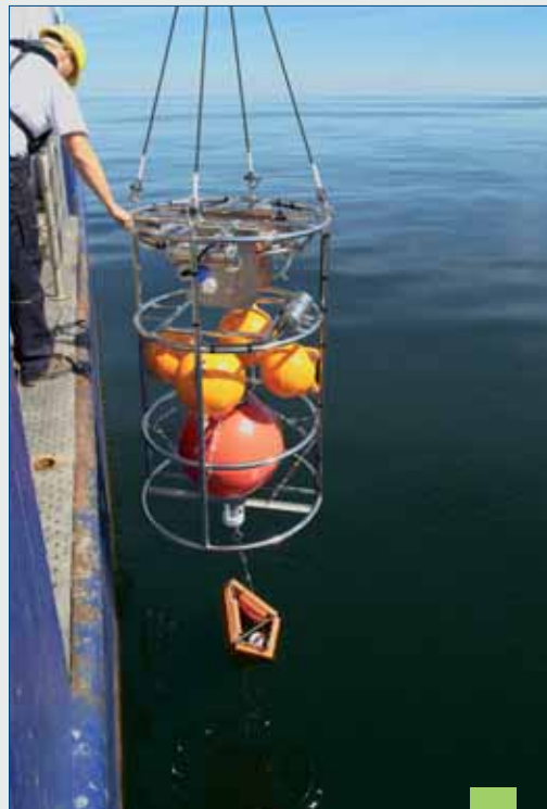
GODESS - DIE UNTERWASSER-WINDE (OBEN) UND DIE PROFILIERENDEN MESSGERÄTE (UNTEN) WERDEN AUSGESETZT. / DEPLOYMENT OF THE UNDERWATER WINCH (TOP) WITH THE PROFILING BODY (BOTTOM). (FOTO: IOW)
