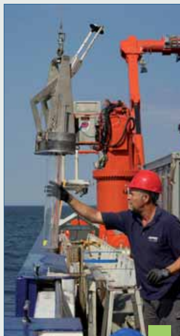
WÄHREND EINER MERIANFAHRT IM SOMMER 2010: MIT DEM „FRAHM-LOT“ WERDEN FÜR DAS BALTIC-GAS-PROJEKT PROBEN AUS DEM MEERESBODEN GENOMMEN. / TAKING SEDIMENT SAMPLES FOR THE BALTIC GAS PROJECT. (FOTO: IOW)
