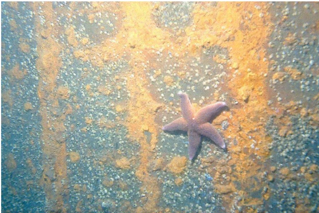
**Abb. 11:** Dez. 2003 (nach 246 Tagen): Seesterne waren häufig bis sehr häufig (1 bis 2 Ind./m<sup>2</sup>) auf dem Stahlrohrsegment zu finden. Die rötlichen Spuren auf dem Stahl sind Rostflecken, die gelegentlich als Placken abfielen und dann am Boden mit der darauf sitzenden Biomasse akkumulierten (s.a. Abb. 9).
