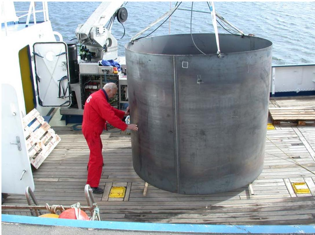
**Abb. 1:** Stahlrohrsegment, welches im April 2003 im Messfeld des IOW an der Darßer Schwelle ausgebracht wurde, um ein Fundament einer WEA zu simulieren.
