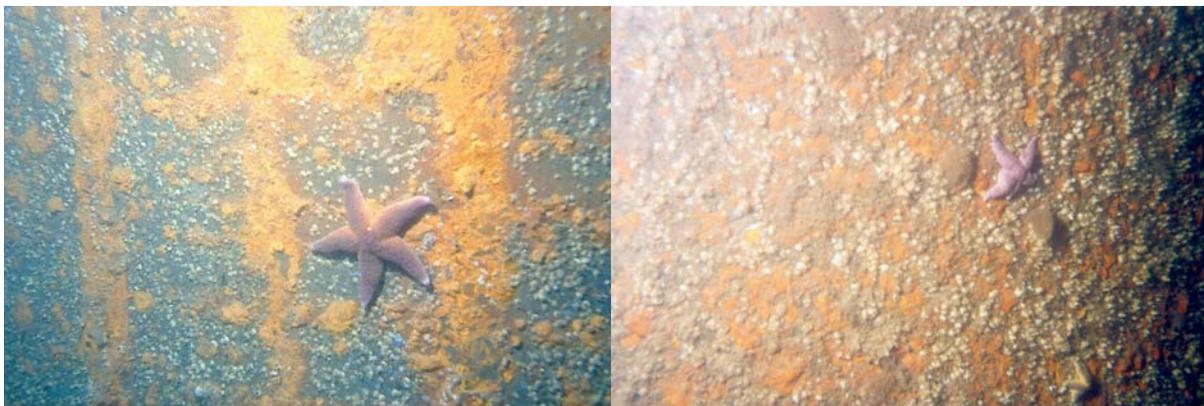
**Abb. 15:** Im Dezember 2003 (nach 246 Tagen Exposition) waren noch weite Teile des Stahlrohrsegmentes frei von Bewuchs (linke Abbildung). Im Mai 2004 (nach 417 Tagen Exposition) war eine fast 100%ige Bedeckung festzustellen (rechte Abbildung).
