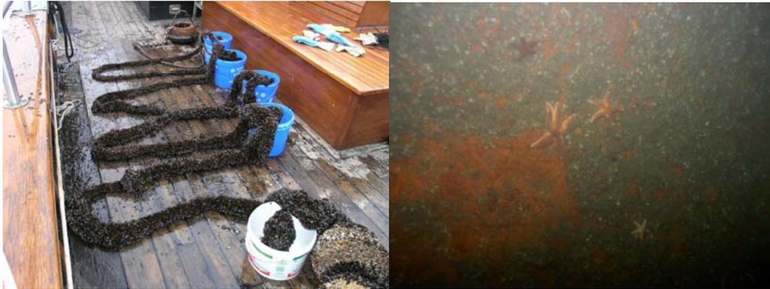
**Abb. 19:** Links: Bewuchsleine im Januar 2005 nach einer Expositionszeit von 177 Tagen. Im Hintergrund ist das Grundgewicht im Vordergrund der Auftriebskörper zu sehen. In den Eimern wurden die Platten zwischengelagert. Rechts: Jan. 2005 (nach 649 Tagen): Seesterne waren häufig bis sehr häufig auf dem Stahlrohrsegment zu finden. Die rötlichen Flächen entstehen wenn Placken abfallen und der darunter liegende Stahl rostet.
