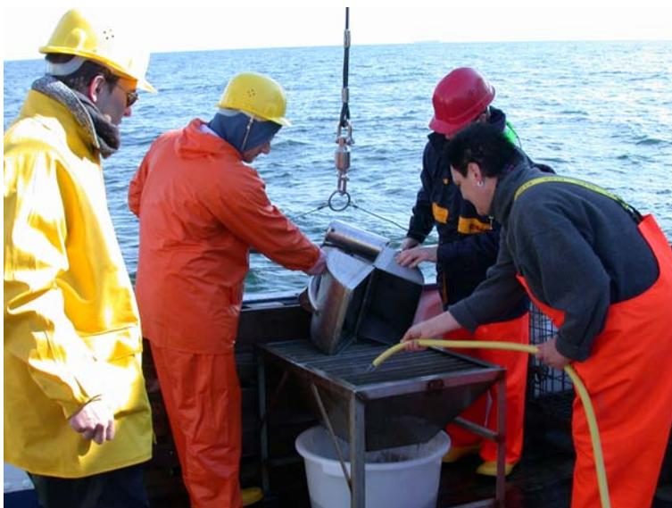
**Abb. 3:** Das Ausspülen der Probe aus dem Greifer in den Auffangbehälter
