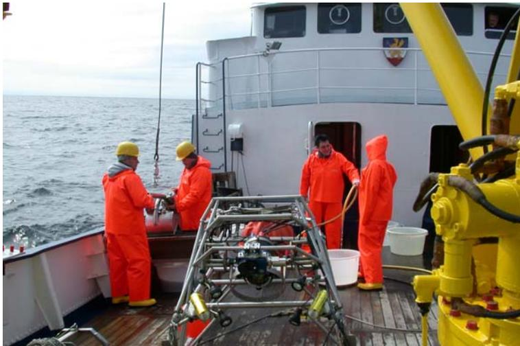
**Abb. 4:** Am Videoschlitten sind sowohl eine Video-Kamera als auch eine digitale Foto-Kamera mit Blitzlicht montiert. Außerdem sind eine externe Stromversorgung (Batteriekugel), 2 Kowalski-Lampen und 2 weitere Lampenpaare mit einer Gesamtleistung von 2200 Watt am Schlitten angebracht. Auf dem folgenden Bild sind 4 gekreuzte Laser, die eine Skalierung des Bildes ermöglichen, zu sehen.
