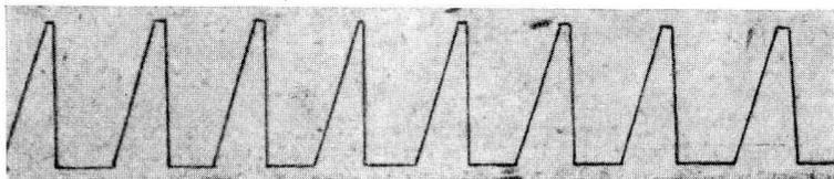
Abb. 4. Registrierstreifen des selbstregistrierenden Strömungsmessers
