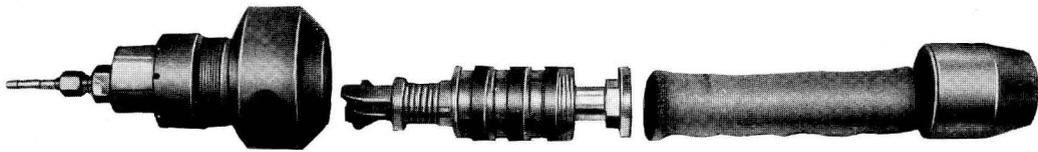
Abb. 6. Anschluß für die Druckpumpe, Kreuzstück und Kolben. Anordnung beim Auspressen der Probe vom hinteren Ende des Rohres her. Beim Auspressen von der Mündung her wird der Apfelsinenverschluß herausgenommen und ein kleiner Kolben eingesetzt. Ein Druckverschluß wird auf das für die Schneide vorgesehene Gewinde geschraubt
