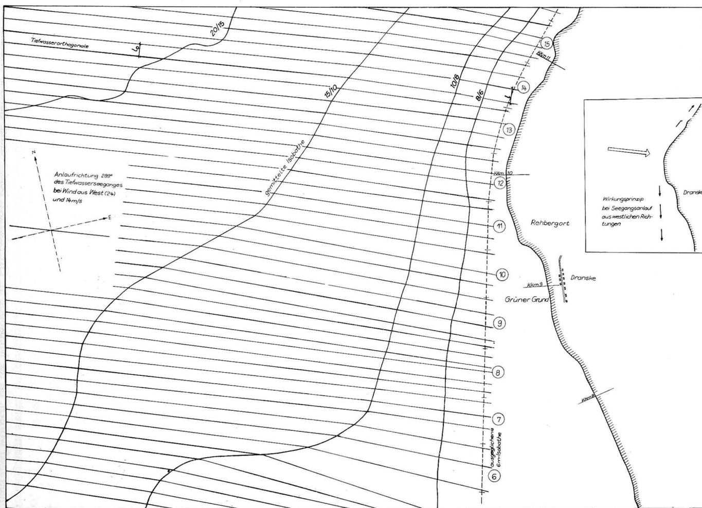
Abb. 9. Refraktionsdiagramm für Wind aus West (24) bei 14 m/s zur Bestimmung der Koeffizientenanteile  $K_{R,i}$
