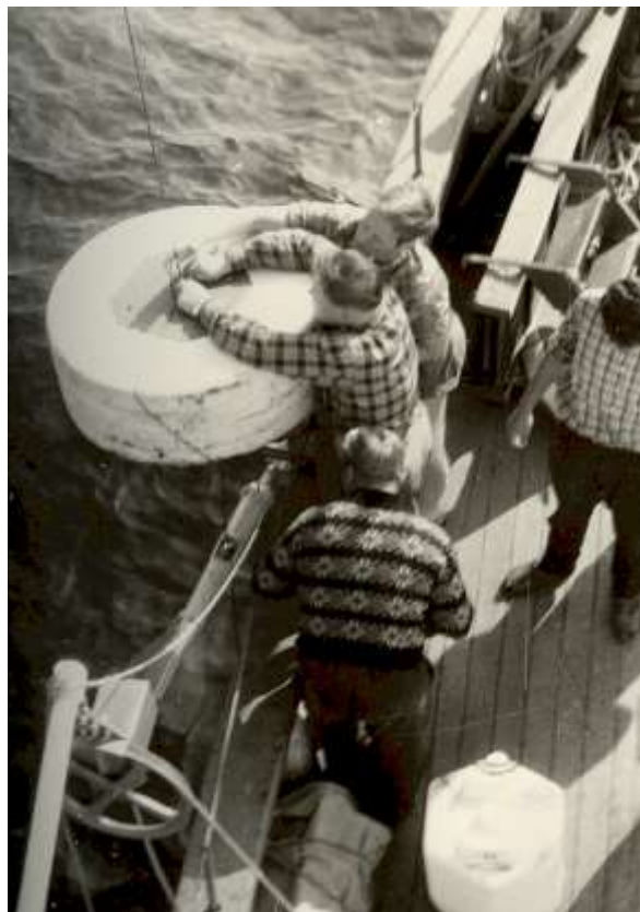
Abb. 47: Aussetzen der Strömungsmesser-Verankerung auf der Darßer Schwelle von Bord des Forschungsschiffes „Professor Otto Krümmel“ während der Internationalen Synoptischen Aufnahme der Ostsee im August 1964. An der Boje R. HELM (unten) und W. MATTHÄUS (Foto: IOW-Bild-Archiv).
