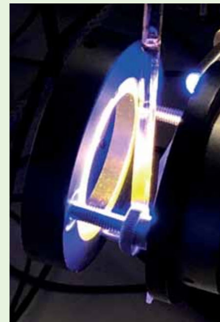
Lässt sich von Licht im blauen und gelben Spektralbereich anregen: Katalysator-Wasser-Gemisch während der Photolyse im Labor am LIKAT. Foto: J. Schneidewind
