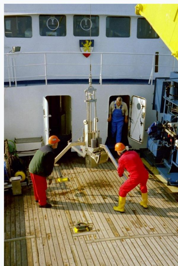
Das Stechrohr mit Bodenproben wird geborgen
