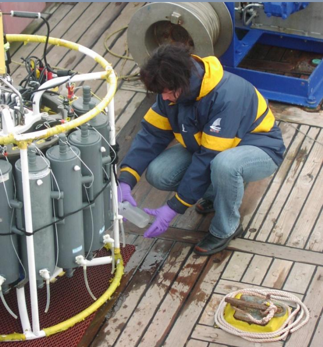
Eine Kollegin beim Abfüllen der Proben aus den Wasserschöpfern der CTD-Sonde.
