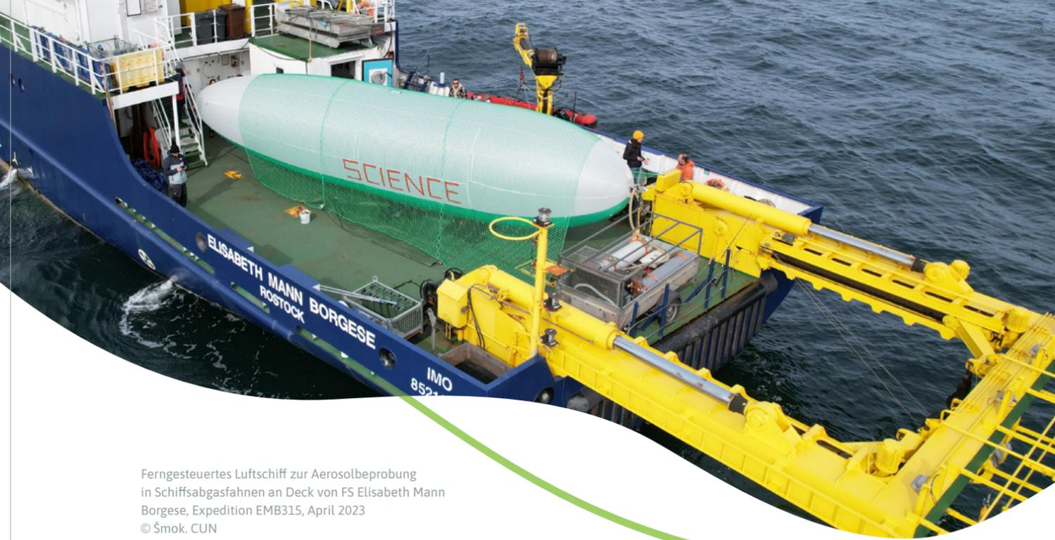
Ferngesteuertes Luftschiff zur Aerosolbeprobung in Schiffsabgasfahnen an Deck von FS Elisabeth Mann Borgese, Expedition EMB315, April 2023
