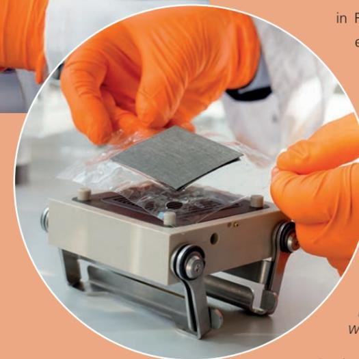
Gustav Sievers (links) und Martin Rohloff kontrollieren die neuartige Membran-Elektroden-Anordnung für Wasser-Elektrolyseure. Foto: INP
