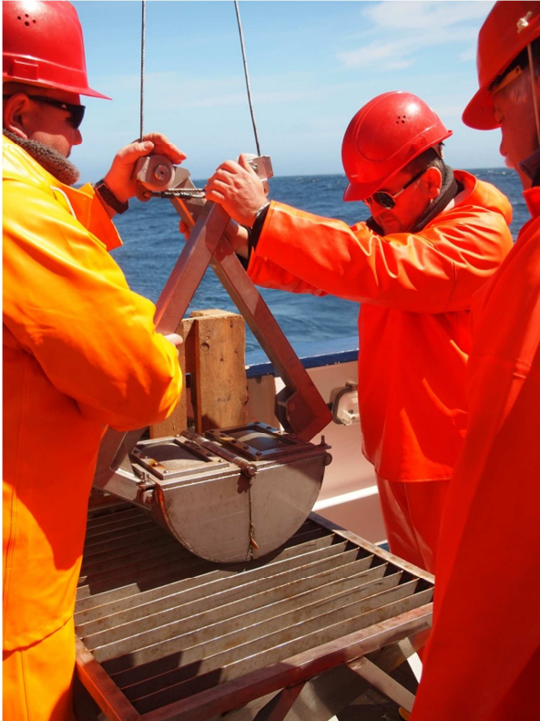
Abb.1: Der van Veen Backengreifer, kam an Stationen bis zu einer Wassertiefe von 200 m zum Einsatz.
