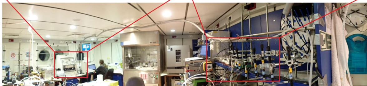
Mikroelektroden-Installation und Nährstoff-Autoanalyser im Chemie-Labor von MERIAN zur kontinuierlichen Messung des Wassers das mit Hilfe der Pump-CTD entlang eines hochauflösenden Vertikalprofils in der oberen Wassersäule entnommen wird (Foto: Sascha Plewe).
